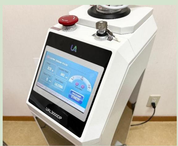
水に吸収される波長10,600nmのレーザー光を発します。皮膚・軟部組織の止血・凝固・切開が可能です。もりあがったホクロやイボを焼灼して除去します。
